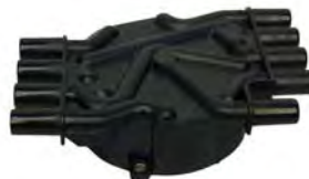
V8 Delco EST Breakerless, 5.0/5.7L Chevy
